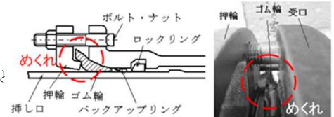
図 接合不良の例
